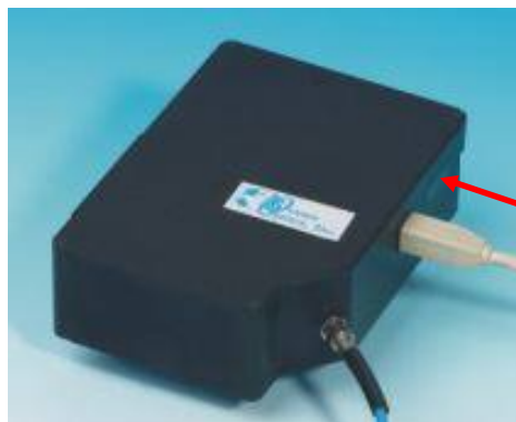
Расположение 30-контактного разъема на корпусе спектрометра HR4000
