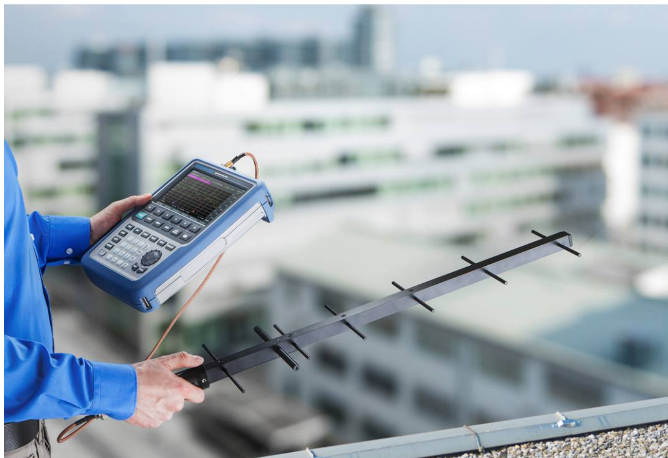
Анализатор R&S®Spectrum Rider FPH с антенной типа волновой канал R&S®NA-Z900
