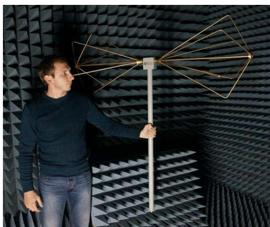
Фото 3. Антенна П6-121 Спец. исполнение для работы в полевых условиях и на мачтах
