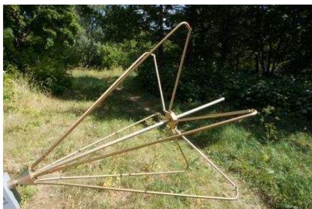
Фото 4. Антенна П6-121 на стадии сборки
