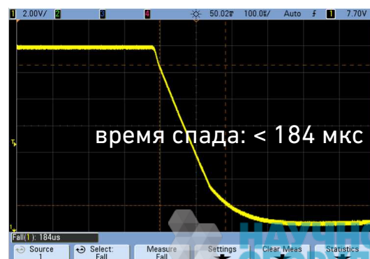
Рисунок 5. Измеренное время спада импульса прерывания составило < 200 мкс
