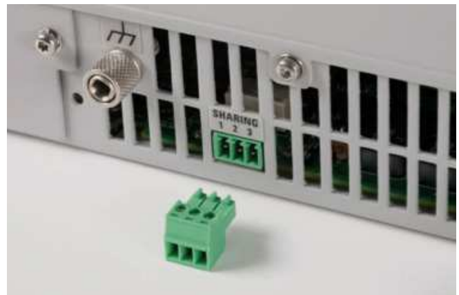
Рисунок 6. Трехконтактный разъем для подключения источников питания APS в режим параллельной работы
