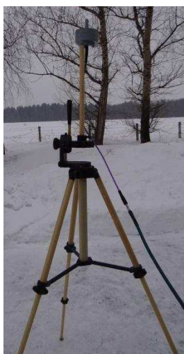
Фото 3. Антенна АС7.23 на диэлектрическом штативе
