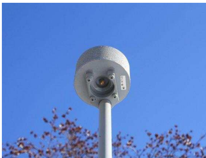
Фото 2. Антенна АС7.23, разъем SMA-типа
