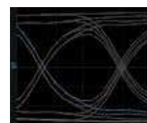
График джиттера, зависящего от данных ( DD_j ) с межсимвольной интерференцией (ISI)
