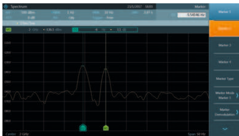
Опция R&S®FPC-B22: высокая чувствительность с полосой разрешения 1 Гц.
