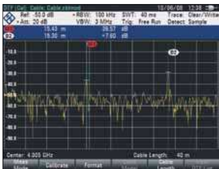
Измерение расстояния до места повреждения (DTF)
