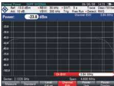
Измерение мощности в канале
