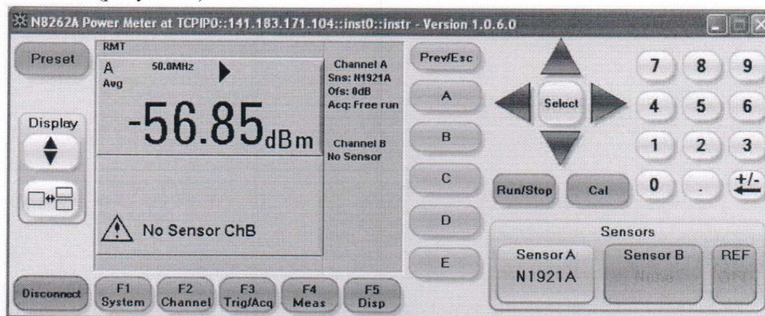
Рисунок 5 – Вид индикаторного экрана блока измерительного в графическом интерфейсе пользователя
