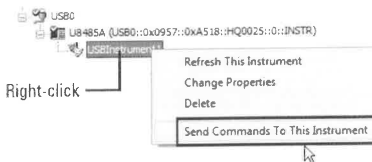
Рисунок 2 – Вид диалогового окна программы в режиме управления преобразователем измерительным
